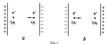
Ein Elektron zwischen zwei Kondensatorplatten
