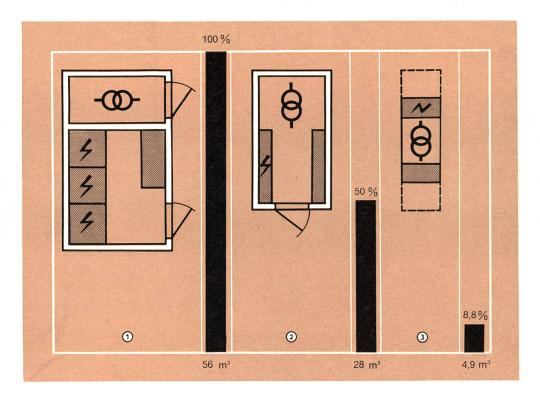
Fig. 12 Raumbedarf verschiedener Bauarten von Transformatorenstationen
