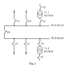
Vereinfachtes Schaltschema eines 16-kV-Unterwerkes
