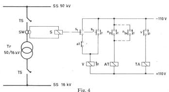
Prinzipschema des Sammelschienenschutzes
