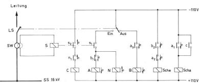
Fig. 3 Prinzipschema des Nahzonenschutzes
