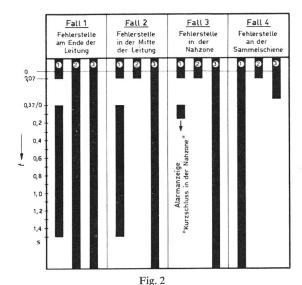
Diagramm der Schalterauslösungen
