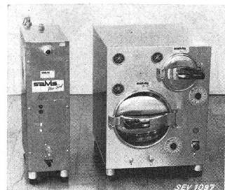
Dampfgenerator mit Gehäuse aus Chromnickelstahl. Wasserbehälter aus Chromnickelstahl mit 3 eingebauten Heizstäben. Sicherheitsschalter, Sicherheitsventil, Signallampe mit Transformator, 2 Kleinsicherungen 500 mA, 3 Sicherungen 35 A, 500 V, Schalter und Anschlussklemmen 3 P+E vorhanden.
