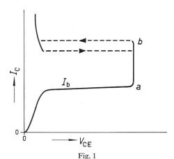
Kennlinie eines vorwärts durchgesteuerten Transistors  $I_{\rm C}$  Kollektorstrom;  $V_{\rm CE}$  Kollektor-Emitterspannung a Primär-, b Sekundärdurchbruch bei Durchsteuerung mit einer Sinushalbwelle auf Ohmsche Last
