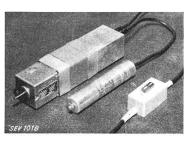
Schutz des Motors vor Überhitzung ist ein Bimetallschalter eingebaut. Gehäuse aus Metall. Zuleitung Td mit Stecker 2 P+E. Der Storenmotor hat die Prüfung in sicherheitstechnischer Hinsicht bestanden. Verwendung: in feuchten Räumen.
