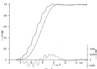
«Niederfrequente Normalkonnente» NK der Spannung am Empfänger-Eingang  $(\Psi_2 = \Psi_1 + \varphi_{\text{T}})$  T Zeit
