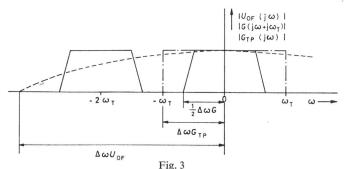
Schematische Darstellung des Betrages der Spektralanteile von  $h_1(t)$  nach Gl. (26)
