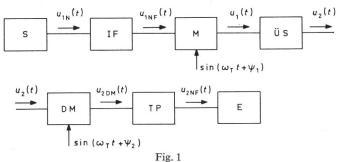
Blockschema für ein Übertragungssystem für amplitudenmodulierte Signale S Sender; IF Impulsformer; M Modulator; US Übertragungsstrecke; DM Demodulator; TP Tiefpass; E Empfänger
