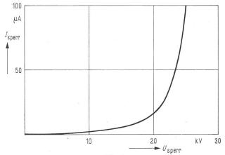
Fig. 1 Sperrkennlinie eines Selengleichrichters Gemessen mit Gleichspannung  $I_{\mathrm{sperr}}$  Sperrstrom;  $U_{\mathrm{sperr}}$  Sperrspannung
