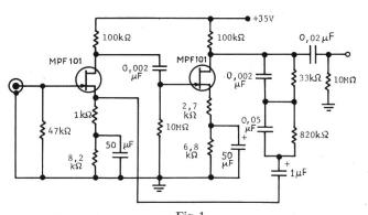
Fig. 1 Vorverstärker mit Feldeffekttransistoren für die Schallplattenwiedergabe mit magnetischem Tonabnehmer
