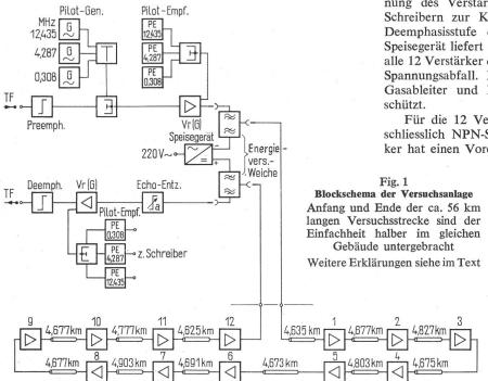
zug, unter der Erdoberfläche, montiert werden. Zur Erprobung wurden 12 Trägerfrequenzverstärker mit Transistoren in einer ca. 56 km langen Versuchsstrecke (Fig. 1) mit einem Koaxialkabel 2,6/9,5 mm unterirdisch verlegt. Die Abstände zwischen den einzelnen Verstärkern sind in Fig. 1 eingetragen. Um die Messungen zu vereinfachen, waren Anfang und Ende der Versuchsstrecke im gleichen Gebäude untergebracht. Am Eingang
