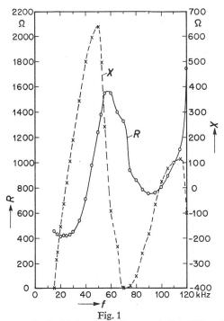
Impedanz in Abhängigkeit von der Frequenz f einer 3660 m langen
