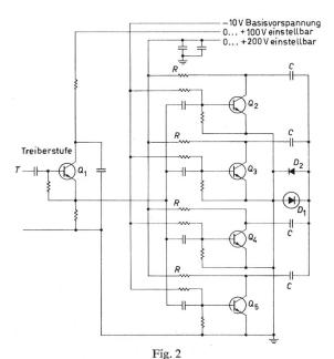
Schaltung des Impulserzeugers mit Avalanche-Transistoren  $Q_1...Q_5$  $D_1$  Laserdiode;  $D_2$  Schutzdiode; R Ladewiderstände; C Ladekondensatoren; T Triggersignal
