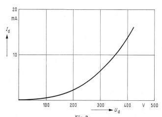
$\begin{array}{c} \text{Fig. 2} \\ \textbf{Durchlasskennlinie eines Selengleichrichters} \\ \text{Gemessen mit einer Zeilenimpulsspannung von 16 kHz} \\ I_{\text{d}} \ \ \text{Durchlaßstrom}; \ \ U_{\text{d}} \ \ \text{Durchlaßspannung} \end{array}$
