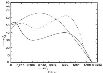
Stromverteilung entlang einer Hälfte der 3660 m langen Dipolantenne bei einer Frequenz von 60 kHz
