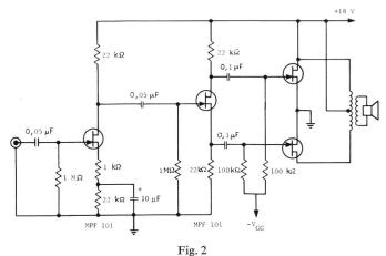
1-W-Verstärker mit Feldeffekttransistoren
