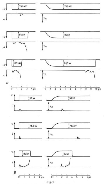
Vorströme bei verschiedenen steilen Stoßspannungen a bei negativer Polarität der Stoßspannungen; b bei positiver Polarität der Stoßspannungen u Stoßspannung; i Vorstrom; Stabfunkenstrecke, a=10 cm
