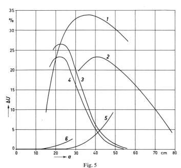
Differenz der 50-%-Stosshaltespannungen bei einer negativen 1 | 50-µs-Welle und einer 0,1 | 50-µs-Welle
