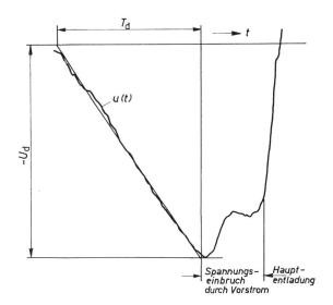
Fig. 8 **Zur Ermittlung der Keilwellenstosskennlinien**  $U_{
