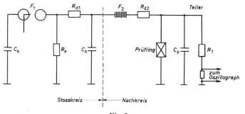
Fig. 3 Schema des Stossgenerators 2
