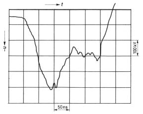
Fig. 6 Abgeschnittene Keilwellen Plattenfunkenstrecke, d=45 cm, a=13,5 cm
