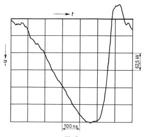
Fig. 7 Abgeschnittene Keilwelle Stab-Plattenanordnung, Platte geerdet,  $a=15\,\mathrm{cm}$
