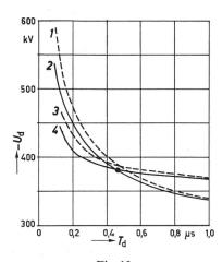
Fig. 10 Keilwellenstosskennlinien
