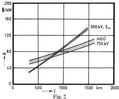
Investitionskosten pro kW Übertragungsleistung k als Funktion der Länge l Übertragungsleistung = 1200 MW; Drehstrom 500 kV mit Längskompensation auf 37° Leitungswinkel (untere Begrenzung des Bandes bei 10 % Verringerung der Kosten für die Schaltanlagen); Hochspannungs-Gleichstromübertragung (HGÜ) 750 kV (untere Begrenzung des Bandes bei 20 % Verringerung der Kosten für die Stromrichter-Stationen)
