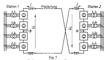
$\begin{tabular}{ll} \textbf{Hochspannungs-Gleichstrom"ibertragung}\\ I \ Gleichstrom; \ \ U_1 \ Spannung \ am \ Gleichrichter; \ \ U_2 \ Spannung \ am \ Wechselrichter \end{tabular}$
