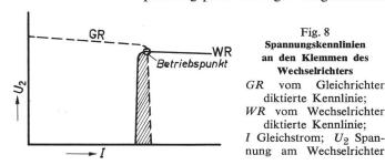
sind, ist die Energierichtung von 1 nach 2, d. h. die Station 1 arbeitet als Gleichrichter und die Station 2 als Wechselrichter.
