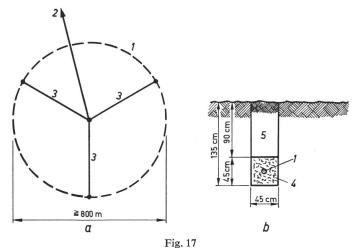
Entwurf der Erdung der Stromrichter-Stationen am Columbia-Fluss
