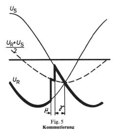
$\mu$  Überlappungswinkel;  $\gamma$  Löschwinkel;  $U_{
