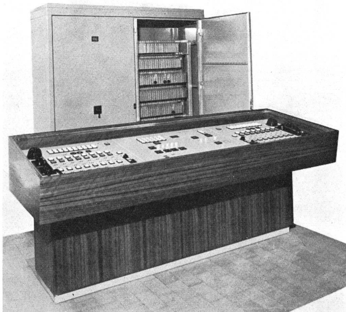
Fig. 7 Programmator für Gasfabrikation
