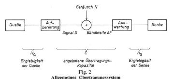
Der durch Geräusch verseuchte Übertragungsweg wird durch Aufbereitungs- bzw. Auswertestationen an Informationsquelle bzw. Senke angepasst. Im allgemeinen Fall enthält die Aufbereitungsapparatur alle für die statistische Anpassung notwendigen Ausrüstungen (Speicher, Umwandler, Koder, Verstärker, Sender, usw.)
