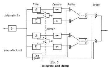
Das F<sub>1</sub>-Signal am Eingang wird im synchronen Bit-Rhythmus abwechselnd an das obere und untere Filterpaar geleitet, wo eine Empfangsfilterung mit hoher Kreisgüte erfolgt. Anschliessend werden die Filterausgänge abgelesen und das so gewonnene Resultat logisch verwertet. Zur Konstanthaltung der Anfangsbedingungen werden die Filter in den Zwischenzeiten entladen
