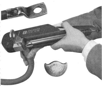
Zur Verwendung mit der PEKA-Blitzpresse eignen sich ausschliesslich Original-PEKA-Kabelschuhe, Verbinder und Abzweigklemmen. 120 verschiedene Abmessungen sind stets sofort ab Lager und Fabrikation in Goldach lieferbar. Auch Sonderwünsche werden berücksichtigt.
