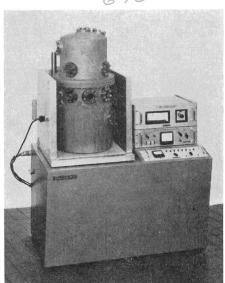
mer, die einen Inhalt von etwa 50 Lit. hat, auf 450 °C ausheizbar einschliesslich der vielen einbaubaren Hilfselementen: Schaugläser, wassergekühlte Hochstromdurchführungen, mechanische und magnetische Drehdurchführungen, Hochspannungs- und Mess-
