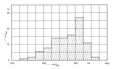
Fig. 7 Streuung von  $U_{\mathrm{BE}}$  für den Si-Transistor 2N3710 bei 100 Exemplaren  $U_{\mathrm{CE}}=5~\mathrm{V};~\vartheta=25~\mathrm{^oC};~I_{\mathrm{C}}=100~\mu A=\mathrm{konst}.$   $f_{\mathrm{rel}}$  relativer Fehler;  $U_{\mathrm{BE}}$  externe Basis-Emitterspannung
