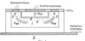
Fig. 4 Schematische Darstellung eines legierten (a) und eines diffundierten Transistors (b)
