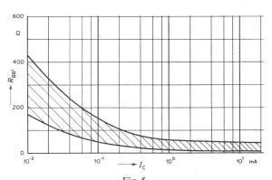
Fig. 5 Gemessene Streuung des Basisbahnwiderstandes  $R_{\mathrm{BB}^{\prime}}$  bei verschiedenen Kollektorströmen  $I_{\mathrm{C}}$  für 100 Si-Transistoren 2N2926 bei  $U_{\mathrm{CE}}=3\,\,\mathrm{V}$  und Temperatur  $\vartheta=25\,^{\circ}\mathrm{C}$
