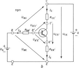
Fig. 1 Darstellung der gewählten positiven Strom- und Spannungsrichtungen a für pnp-Transistoren, b für npn-Transistoren
