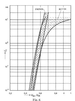
Gemessene Streuung der Spannung zwischen Basis und Emitter  $U_{\rm BE}$ ,  $U_{\rm EB}$  bei jeweils konstantem Kollektorstrom  $I_{\rm C}$  für 100 Si-Transistoren 2N2926 und BCY34 bei  $U_{\rm CE}$  bzw.  $U_{\rm EC}=3$  V und Temperatur  $\vartheta=25$  °C
