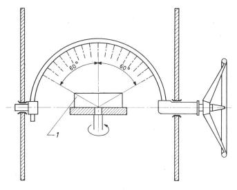
Innendurchmesser des Rohres 15 mm Löcher von 0,4 mm Durchmesser in den Spritzdüsen, die im Abstand von 50 mm auf der Innenseite des Rohrbogens über einem Winkel von  $60^\circ$  auf beiden Seiten der Vertikalen angeordnet sind 1 Prüfling
