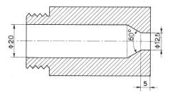
Fig. 5 Strahlrohr
