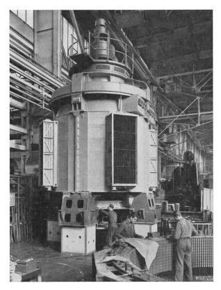
Vertikalachsiger 60-MVA-Dreiphasengenerator von BBC für ein Wasserkraftwerk während der Montage
