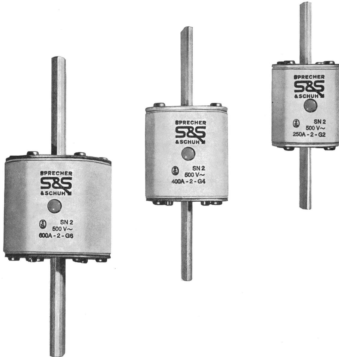
Die Patronen der neuen Baureihe Typ SN 2 kombinieren die Vorteile der zwei Trägheitsgrade. Der träge Teil erlaubt hohe Anlaufströme und der nachfolgende flinke Teil ermöglicht eine starke Strombegrenzung bei hohen Kurzschlussströmen.
