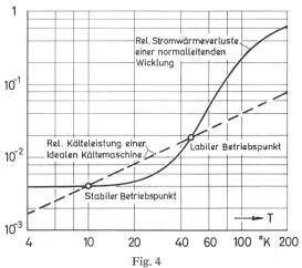
Abhängigkeit der relativen Kälteleistung einer Kältemaschine und der relativen Stromwärmeverluste einer Wicklung von der Temperatur T
