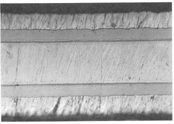
$\begin{array}{c} Fig.~3\\ \textbf{Schliff durch ein Nb}_3\textbf{Sn-Band mit Stahlunterlage}\\ Gesamtdicke einschliesslich Verkupferung etwa~100~\mu m\end{array}$
