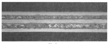
$\begin{array}{c} Fig.~2 \\ \textbf{Schliff durch ein Nb}_{3}\textbf{Sn-Diffusionsband} \\ Dreifachband;~Dicke~40...45~\mu m \end{array}$
