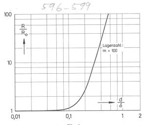
Fig. 1 Abhängigkeit des relativen Wirkwiderstandes  $R/R_0$  einer mehrlagigen, verdrillten wechselstromdurchflossenen Wicklung (Nutenleiter) vom Verhältnis Teilleiterstärke d zu Eindringtiefe  $\delta$
