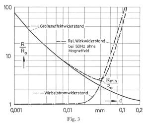
Abhängigkeit des relativen Wirkwiderstandes  $R/R_0$  einer mehrlagigen, verdrillten, wechselstromdurchflossenen Wicklung (Nutenleiter) in Abhängigkeit von der Teilleiterstärke d für  $\delta=0.2\,$  mm und  $l=0.04\,$  mm
