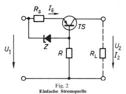
$I_{\rm E}$  Emitterstrom; R Vorwiderstand der Zenerdiode Z;  $R_{\rm s}$  Shunt zur Stromerfassung; Z Zenerdiode Weitere Bezeichnungen siehe Fig. 1
