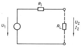
Fig. 1 Ersatzschema der Stromquelle
