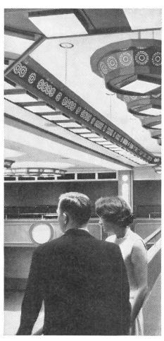
Vielfältig sind die Gestaltungsmöglichkeiten mit Panel-F-Lampen. In diesem Hotel-Ballsaal sind zwei Sektionen: oben die weissen Lampen mit farbigen Filtern, und etwas tiefer die Reihen der matten Lampen, die im ganzen Raum für gleichmässiges Licht sorgen.
