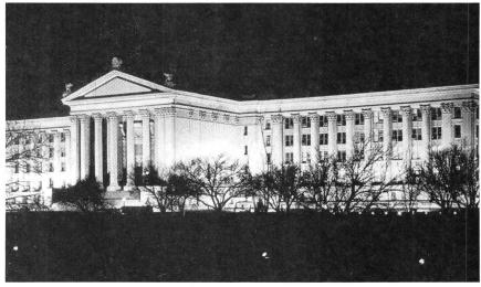
Dieses Regierungsgebäude wird von 1000-Watt-Lampen angestrahlt. Um den grössten Lichtausstoss zu erreichen, verwendete man hier Lampen mit weissem Phosphorüberzug. G-E produziert jedoch auch farbverbesserte Typen, das heisst, das natürliche Blaugrün wird durch ein angenehmes Rot ergänzt.
