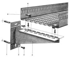
Les dispositifs de fixation sont normalisés pour le montage au plafond et à la paroi. Les chemins de câbles HEER sont livrables en 5 largeurs: 140, 210, 280, 350 et 420 mm, avec tous accessoires, soit: coudes horizontaux et verticaux, pièces T et + avec réductions et embranchements de 0 à 90°, équerres et pièces d'arc intérieures et extérieures.
