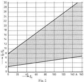
Der Streubereich des Einschaltstromes  $I_E$  zum Ausschaltstrom  $I_A$  bei Schützenspulen, in Abhängigkeit von der Nennstromstärke  $I_n$  der Schütze
