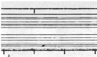
Fig. 11 Querfehler im Schienenkopf
