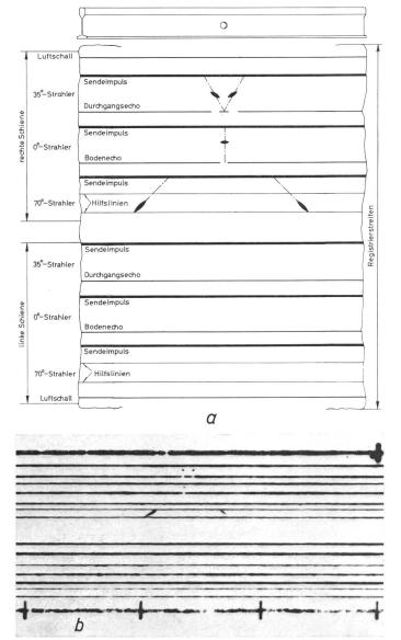
Fig. 10 **Einzelne Bohrung im Schienensteg** *a* schematische Ansicht und konstruiertes Registrierbild;
