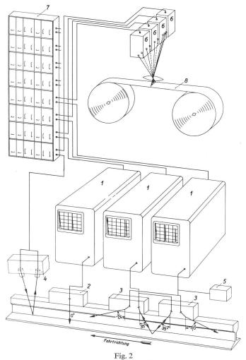
Schematische Darstellung der im Schienenprüfzug verwendeten Anordnung der Schallwandler und ihrer Zuordnung zu den elektronischen Geräten und den Bildröhren
