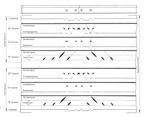
Fig. 13 Schematische Darstellung der Registrierung einer fehlerfreien Laschenkammer
