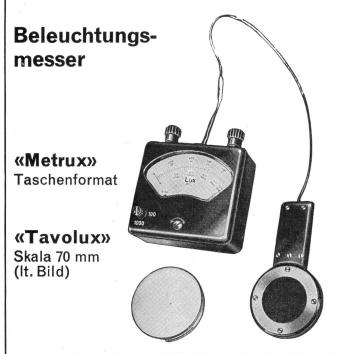
je mit 2 Bereichen: 100/1000, 300/3000, 500/5000 Lux mit oder ohne Augenkorrektionsfilter. Hochempfindliche Luxmeter für Strassen-Beleuchtung usw. Aufsteck-Filter mit Faktor 1:10, 1:50 oder 1:100.
