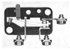
Fig. 3 Längsschnitt durch einen Mikroschalter mit einteiliger Kippfeder
