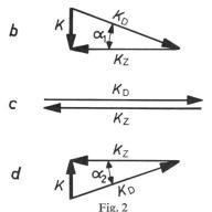
Bildung der Kontaktkraft durch Kraftkomponenten an einem «Miltac»-Mikroschalter der SAIA AG, Murten
