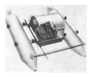
Die Empfindlichkeit dieses Gerätes, das mit periodisch eintauchenden Elektroden arbeitet, ist erheblich grösser als die eines Gerätes mit starr angeordneten Eintauchelektroden. Während diese nur bei ruhendem Wasser und dicken Ölschichten ein sicheres Messergebnis liefern, spricht das neue Ölwarngerät mit rotierendem Elektrodenrad bereits auf sehr dünne Schichten zuverlässig an.
