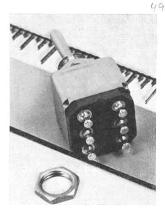
leistet, da die Masse des Schalthebels in einem ausgewogenen Verhältnis zu Schalt- und Rückstellkräften stehen. Der grosse Schaltwinkel erleichert zudem ein sofortiges Erkennen des Schaltzustandes. Die Schaltleistung beträgt 5 A, 110 V∼ oder 30 V₋bei Ohmischer Last. Bei induktiver Last beträgt der Nennstrom je 2 A. Diese für ein derart kleines Schaltgerät relativ hohe Schaltleistung wurde dank einem neuen Plastikgehäuse mit überragenden mechanischen und elektrischen Eigenschaften möglich.
