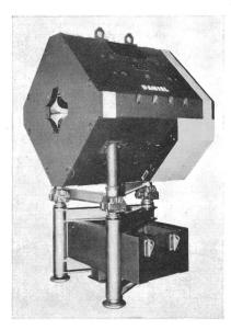
1550 A Erregergleichstrom und einer Leistung von 400 kW, welche mittels direkter Leiterkühlung durch 130 l/min Wasser bei 4 kp/cm² Druckdifferenz abgeführt wird. Die Gesamtlänge des Quadrupols beträgt 1370 mm, das Gewicht 9800 kg.
