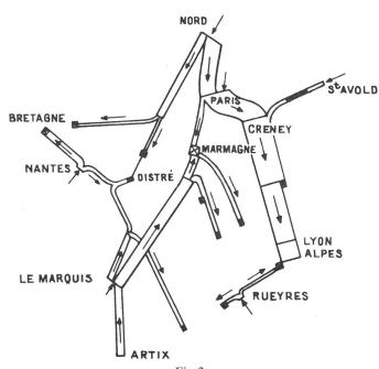
Fig. 2 Leistungsübertragung auf dem französischen 225- und 400-kV-Netz am 22. Januar 1964 um 3 h bei geringem Wasserkraftanfall
