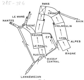
Fig. 1 Leistungsübertragung auf dem französischen 225- und 400-kV-Netz am 24. März 1964 um 10 h bei starkem Wasserkraftanfall
