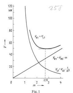
Graphische Darstellung zur Ermittlung des optimalen Dichteverhältnisses für eine Überdruckbelüftung
