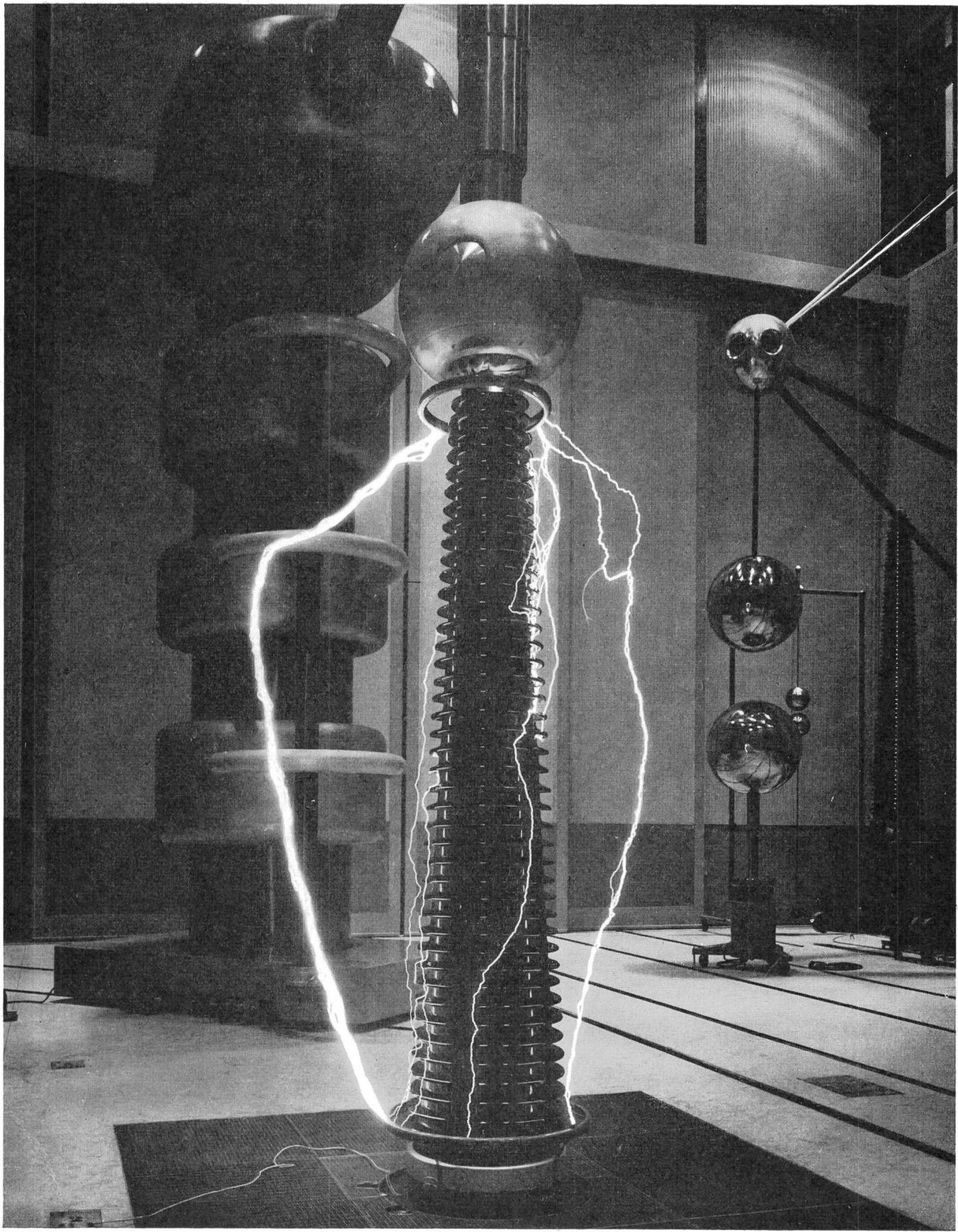
Dieses Bild zeigt eine 710-kV-Transformator durchführung während der Bestimmung der 50-Hz-Überschlagsspannung. Der Überschlag erfolgt bei 1 Million Volt.
