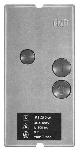
Der Fehlerstromschutzschalter spricht auf Fehlerströme an, d.h. auf diejenigen Ströme, die nicht mehr durch die zuführenden Leiter, sondern über Erde oder Schutzleiter zurückfliessen.
