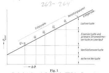
Totalverluste  $P_{\mathrm{d} \ \mathrm{tot}}$  in Funktion der Kühllufterwärmung  $\Delta \ \vartheta$
