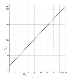
Fig. 2 Total verluste  $P_{\rm d~tot}$  in Funktion der Thermospannung  $U_{\rm th}$  (Eichkurve)
