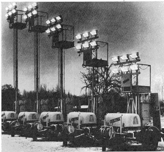
Fig. 1 Einachsanhänger mit Flutlichtanlage
