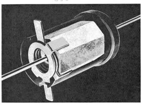
Es handelt sich dabei um eine hermetisch glas-verkapselte Diode in einer selbstregulierenden polykristallinen Wärmezelle. Eine isolierende Spritzgussnylon-Ummantelung schützt die Zelle vor Feuchtigkeit und mechanischer Beschädigung.
