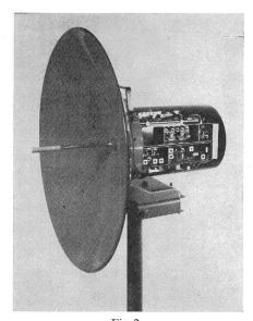
Fig. 2 Sende-Empfangsgerät
