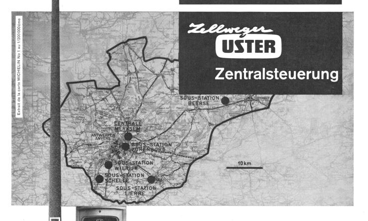
Durch direkten Anschluss der Leuchten an das allgemeine Versorgungsnetz mit Steuerung durch einzelne Empfänger wurden die Kosten für Strassenbeleuchtungs-Anlagen um 30% gesenkt.
