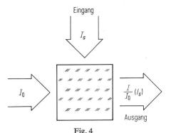
Nichtlineare Steuerung eines Laserverstärkers durch Sättigung I Ausgangssignal;  $I_0$  Eingangsstrahlung;  $I_s$  Steuersignal
