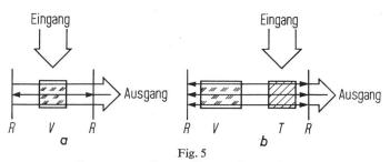
Steuerung von Laseroszillatoren durch Sättigung
