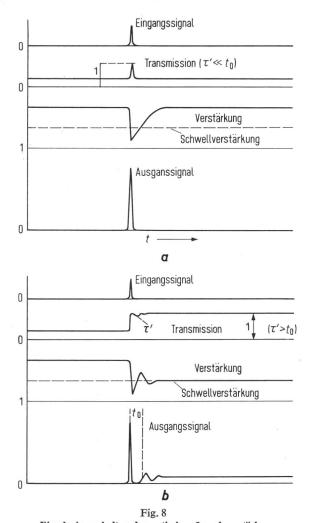
**Einschwingverhalten des optischen Impulsverstärkers**a monostabiler Fall; b bistabiler Fall; τ' Relaxionszeit des Schaltmaterials; t<sub>0</sub> Einschwingzeit des Oszillators
