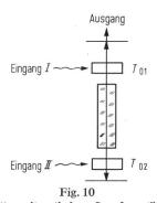
Gatter mit optischem Impulsverstärker  $T_{01}$  Anfangstransmission des Schalters  $I;\ T_{02}$  Anfangstransmission des Schalters II
