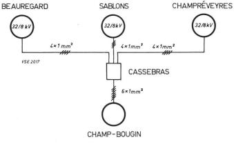
Fig. 2 Steuernetz für die drei Einspeisungen Cassebras: Verteiler
