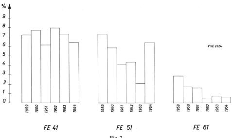
Fig. 7 Jährliche Reparaturquote an Empfängern in  $^{\rm 0}/_{\rm 0}$  FE 41, FE 51 und FE 61
