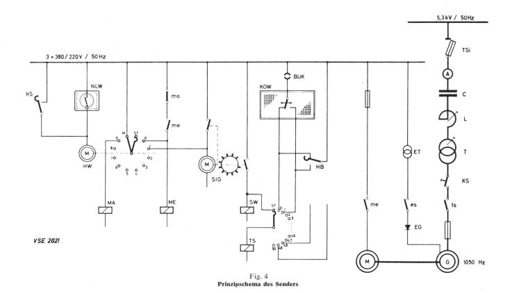
wählers SW auf einen Kontakt kommt, der vom Koordinatenwähler aus Spannung erhält, schaltet der Sendeschalter ts von neuem ein.
