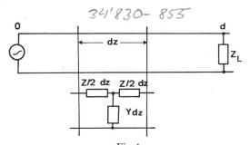
Fig. 1 **Leitung der Länge** d, **abgeschlossen mit der Belastung**  $Z_L$ Für ein Teilstück dz ist die Serieimpedanz Zdz und die Paralleladmittanz Ydz
