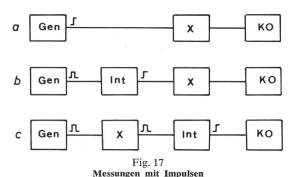
a Einheitssprünge; b integrierte Delta-Funktionen; c Störung mit Delta-Funktionen und Integration der Antwort. Mit X ist das geprüfte Element bestimmt
