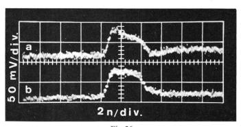
Fig. 26 Impulsgenerator mit Tunnel Diode a konventioneller Aufbau; b gedruckte Schaltung und «MW»-Cartridge»
