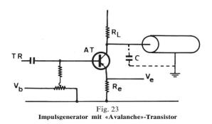
Strom bildet. Wenn ein Transistor so arbeitet, kann er gut als Impulsgenerator gebraucht werden.
