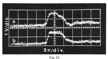
Impulsgenerator von Fig. 23 a konventioneller Ausbau; b gedruckte Schaltung
