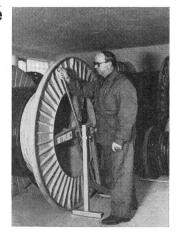
Für Trommeln bis 2000 kg und 75–160 cm Durchmesser Pour tambours jusqu'à 2000 kg et  $\varnothing$  de 75 à 160 cm
