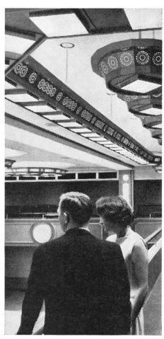
Vielfältig sind die Gestaltungsmöglichkeiten mit Panel-F-Lampen. In diesem Hotel-Ballsaal sind zwei Sektionen: oben die weissen Lampen mit farbigen Filtern, und etwas tiefer die Reihen der matten Lampen, die im ganzen Raum für gleichmässiges Licht sorgen.
