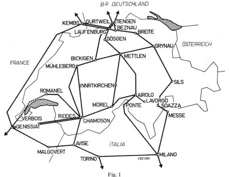
Schema des schweizerischen Höchstspannungsnetzes
