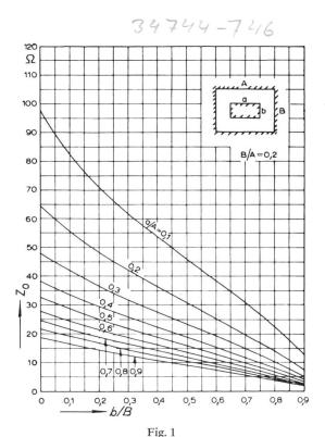
Wellenwiderstand  $Z_0$  einer rechteckigen Koaxialleitung mit einem Seitenverhältnis B/A=0,2
