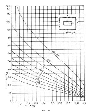
Fig. 2 Wie Fig. 1, aber mit einem Seitenverhältnis von B/A=0.4
