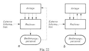
Grundschaltungen der Automatisierung eines Dampfkraftwerkes a Open Loop-System; b Closed Loop-System
