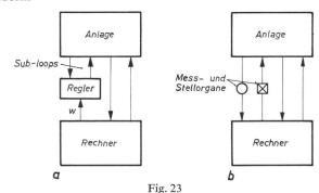
Möglichkeiten der Einschaltung eines Prozessrechners im Zusammenhang mit der Regelung eines Dampfkraftwerks
