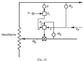
Beispiel der Grundschaltung der Druck-Leistungsregelung des Dampferzeugers
