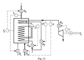
Beispiel der Grund-Regelschaltung eines Dampfkraftwerks (Trommelkessel, Turbine mit Drehzahl-Leistungsregelung)
