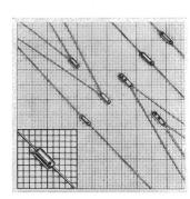
Man findet am Stand auch sämtliche den MIL-Normen entsprechende Kondensatoren. Die Ausführung aller dieser Kondensatoren in hermetisch verschlossenen Metallbechern erlaubt eine Verwendung in Temperaturgrenzen von -80 bis ±125 °C.
