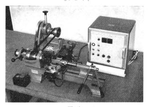
Fig. 1 Hydropneumatischer Schlittenantrieb und Steuergerät einer automatischen Drehbank
