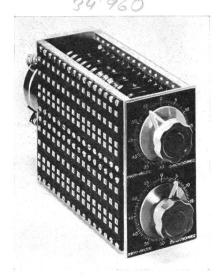
mit 60 Mikroschaltern, 30 Doppel-Nockenscheiben und einem Synchronmotor zum Antrieb von zwei Nockenpellen versehen.
