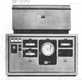
Fig. 1 Hochtemperatur-Rohrofen für die Materialforschung
