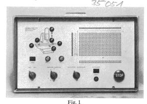
Steuerkasten für die automatische Steuerung einer Fräsmaschine
