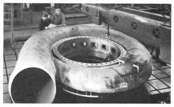
Fig.~1 Spiralgehäuse einer Pumpenturbine von 40 000 kW
