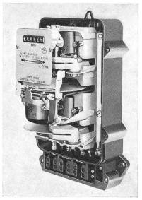
Fig. 1 Vierleiter-Elektrizitätszähler mit 3 Meßsystemen
