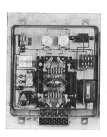
Fig. 3 Statischer Frequenzumformer
