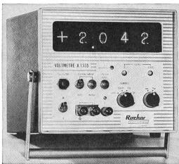
ROCHAR-Kompakt-Digitalvoltmeter für Gleichund Wechselspannung mit automatischem Bereich, 4 Modelle, Druckerausgang auf Wunsch
