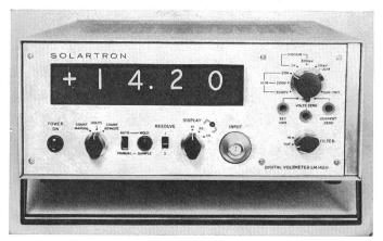
SOLARTRON-Präzisions-Digitalvoltmeter mit 4und 5stelliger Anzeige. Grosse Flexibilität, hohe Auflösung und hohe Messgeschwindigkeit- mit Druckerausgang
