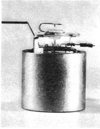
Luftspalt zwischen dem Kernmagnet mit hoher Koerzitivkraft und dem Weicheisenpolring. Das Messwerk wird durch den Eisenring gleichzeitig magnetisch abgeschirmt. Dadurch entfällt die übliche Nacheichung beim Einbau in verschieden dicke Blechtafeln.
