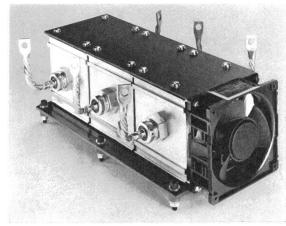
Fig. 10 Kühlkörper mit aufgesetztem Ventilator
