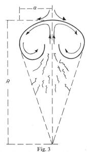
Querschnitt durch ein unsichtbares Ziel Das unsichtbare Ziel ist eine Art Luftblase, die durch Luftströmungen gebildet wird a Radius der Luftblase; R Höhe ihres Scheitelpunktes
