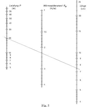
Wärmewiderstand von verschiedenen Kühlkörpern als Funktion von Länge der im Halbleiter vernichteten Leistung
