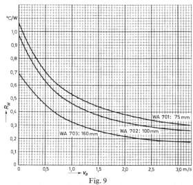
Wärmewiderstand von Kühlkörpern der Serie WA 700 bei forcierter Kühlung
