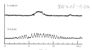
Fig. 1 Aufnahme eines unsichtbaren Radarzieles
