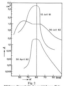
Mittlerer Querschnitt der unsichtbaren Ziele Der Querschnitt A erreicht in der Regel bei einem Elevationswinkel α von 90° ein Maximum
