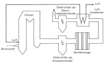
Fig. 25 Verfahrensschema einer Rauchgasentschwefelung
