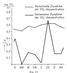
Zunahme der SO<sub>3</sub>-Konzentration nach Inbetriebnahme eines 150-MW-Blockes
