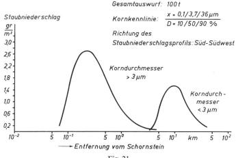
Fig. 21 Staubniederschlagsprofil aus einer 116 m hohen Quelle
