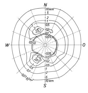
Fig. 20 Staubniederschlag in der Umgebung eines Schornsteines
