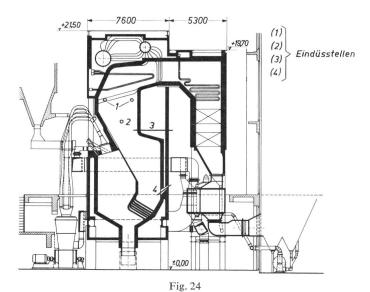
Kraftwerk Kellermann Kessel für 80 kg/cm² mit Schmelzfeuerung
