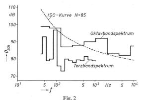
Geräuschspektrum neben dem Aussenlager der Turbine  $p_{Sch}$  Schallpegel; f Geräuschfrequenz
