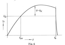
Zur Berechnung von Stosskennlinien U Stoßspannung;  $U_H$  Stosshaltespannung; t Zeit;  $t_a$  Ansprechverzug
