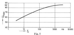
Einfluss der Frontdauer auf die Stosshaltespannung einer Funkenstrecke Stab-geerdete Kugel bei negativer Polarität der Stoßspannung  $U_{H\ abs}$  absolute Stosshaltespannung;  $T_s$  Frontdauer
