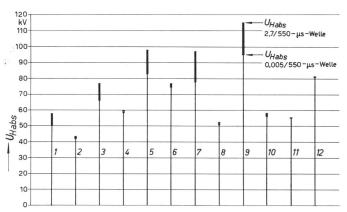
Fig. 4 Haltespannungen verschiedener Elektrodenanordnungen  $U_{H\ abs}$  absolute Stoßhaltespannung
