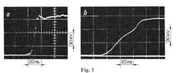
Front der Stoßspannung beim Einsatz einer Vielfachplattenfunkenstrecke und einer Kugelfunkenstrecke
