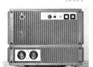
und schüttelfest. Spezielle Fuss-Schwingelemente dämpfen selbst die härtesten Schläge. Mit einer zusätzlichen Frontplatte wird auch Rackmontage ermöglicht. Das Aluminiumgehäuse dient gleichzeitig als Kühlradiator.
